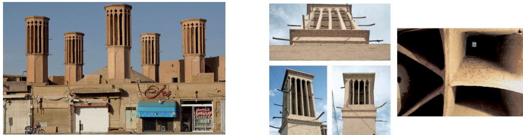
Figura 10. Esempi di torri del vento (Iran) e particolare dell'interno di una torre.
