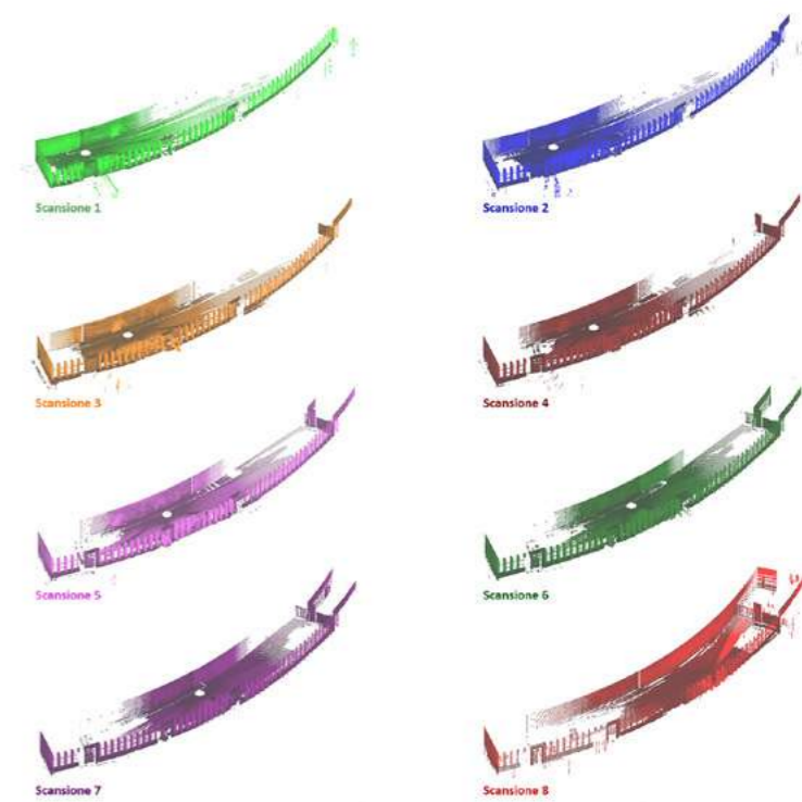
Faro Focus X 330 Laser Scanner a differenza di fase. Numero scansioni: 8. Tensione media dei punti di scansione: 1.4738. Tensione media inferiore a 4 mm per l'84,6% dei punti di scansione.
