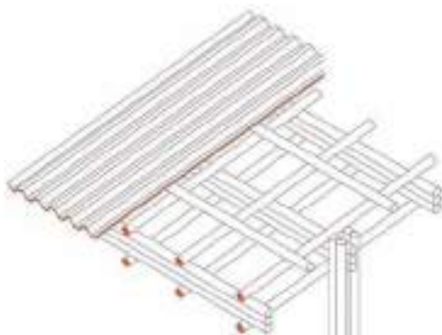
DETTAGLIO ATTACCO SOLAIO-COPERTURA
