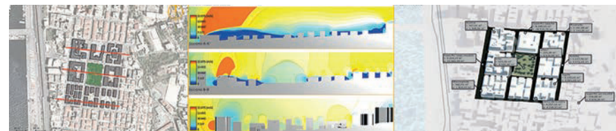
Fig. 3. Valutazione emissività materiali sotto carico termico e simulazione flussi d’aria in un distretto urbano campione (fonte: ricerca PRIN 2015).
