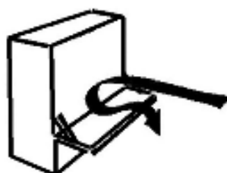
Esempio di contromisura per l'effetto di dilavamento. Veranda alla base dell'alto edificio.
