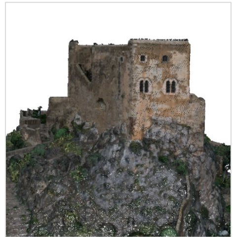
Fig. 4 - Immagine ottenuta dalla nuvola di punti (elaborazione grafica delle autrici, 2024).
