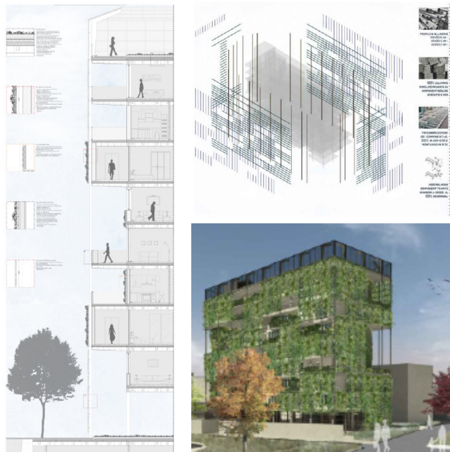
Fig. 27. SX: Sezione cielo terra esemplificativa del funzionamento del funzionamento definitivo del componente di involucro progettato. DX Alto: Esploso assometrico. DX Basso: Vision Finale. R. Raso, 2021
