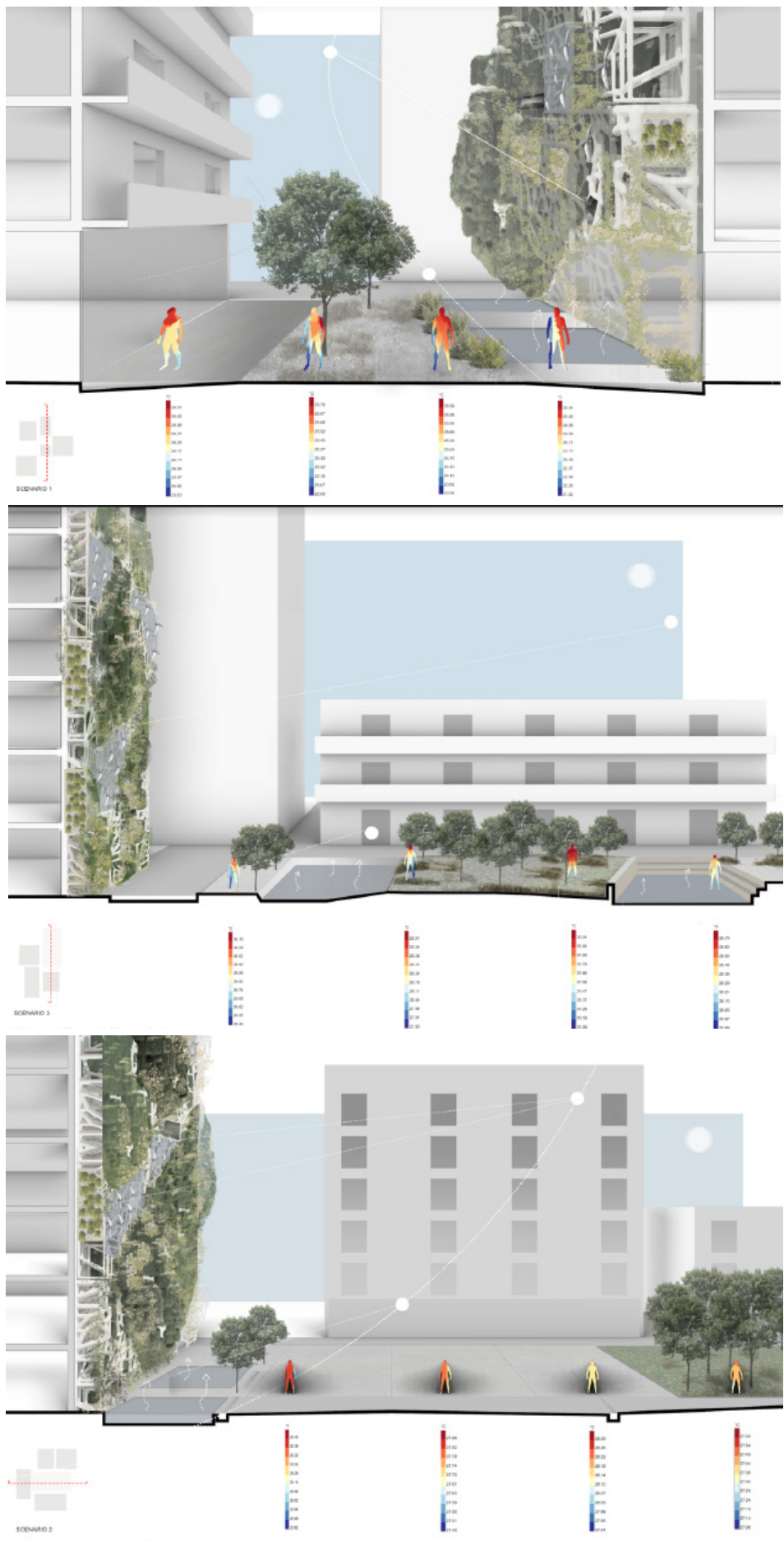
Fig. 28 . Scenari di Sperimentazione. Analisi del microclima considerando l'applicazione del GRS. Lavoro degli studenti all'interno del TRL Lab Exp. 2022.
