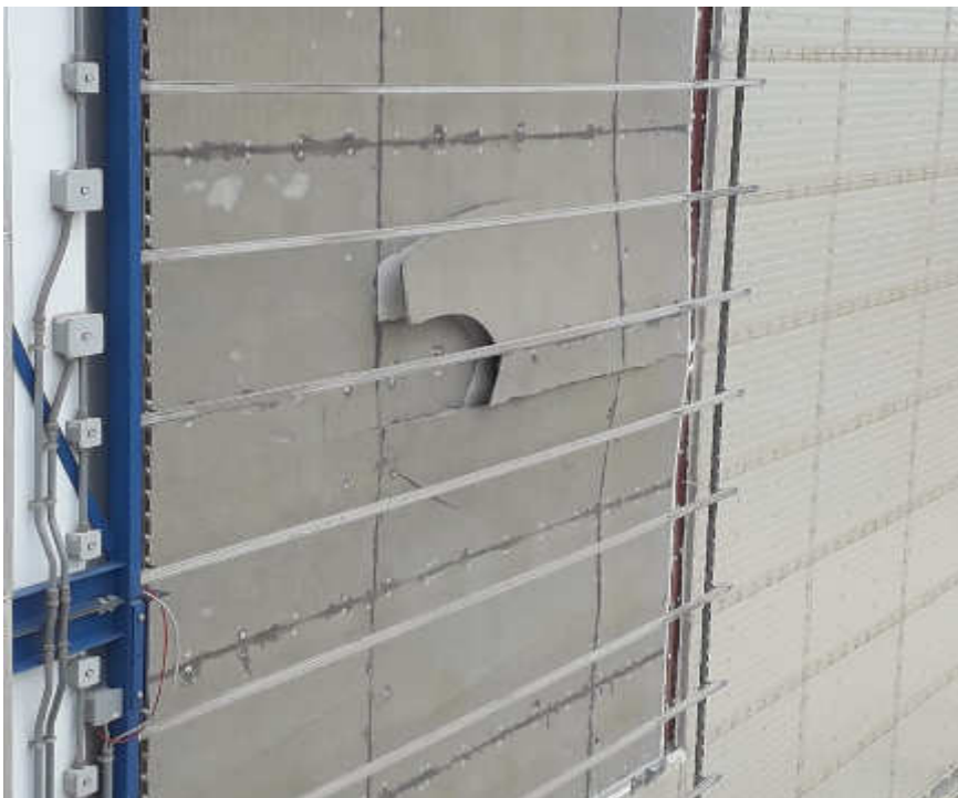
Fig. 35 - Esito simulazione di carico e pressione del vento: Rottura / Wind load and wind pressure simulation result: Breakage (Source: Authors' elaboration).
