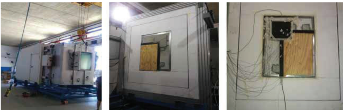
Figura 05 – Test-Cell di Simulazione Climatica per test accelerati indoor e outdoor.
