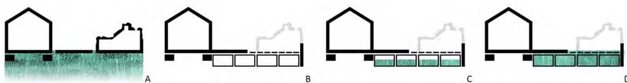
4: Schemi delle diverse fasi delle 'Piazze d'acqua' – Elaborazione Laboratorio di ricerca Landscape_inProgress: A_ Stato di fatto 1 – Il suolo al di sotto dei manufatti fatiscenti diventa una ferita nel corpo della città provocando la vulnerabilità del tessuto urbano; B_ Progetto. Stato 2 – La superficie della piazza durante i periodi privi di precipitazione atmosferiche; C_ Progetto. Stato 3 – Il suolo permeabile assorbe e convoglia l'acqua durante le precipitazioni atmosferiche di media durata; D_ Progetto. Stato 4 – La piazza si trasforma in uno specchio d'acqua durante le precipitazioni atmosferiche intense.
