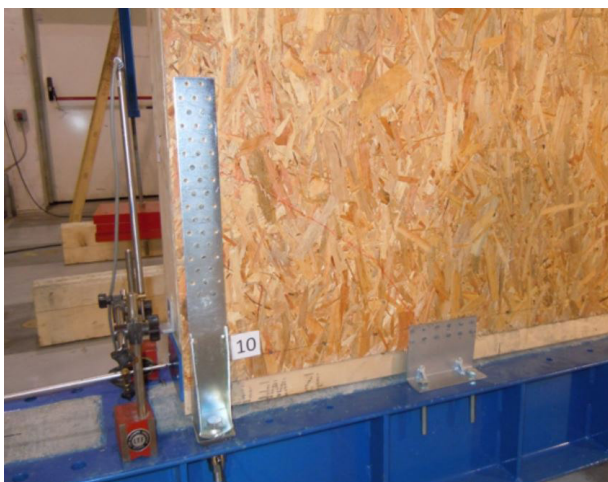
Test ciclico di comportamento di una connessione ad un muro in OSB, Università di Trento. https://www.dicam.unitn.it/217/timber-structures
