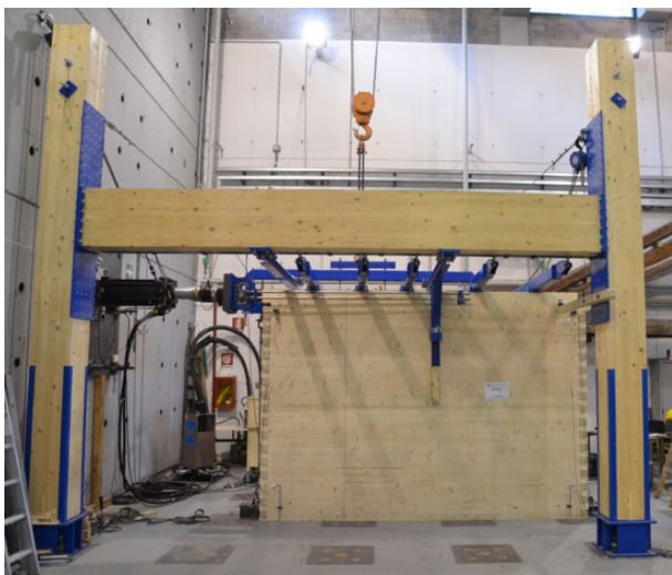
Test ciclico di comportamento al taglio di un muro in cross lam, Università di Trento. ( https://www.dicam.unitn.it/217/timber-structures )
