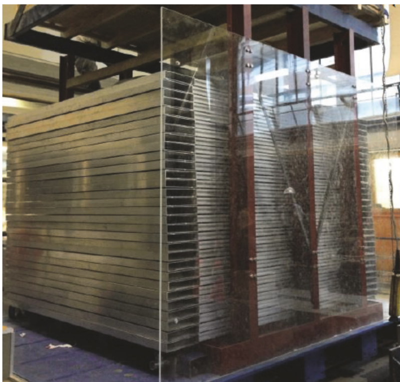
Figura 2.8 Laminar container presso l'Università di Auckland
