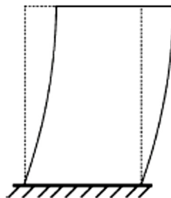
Figura 1.3 Schema di una trave soggetta a taglio
