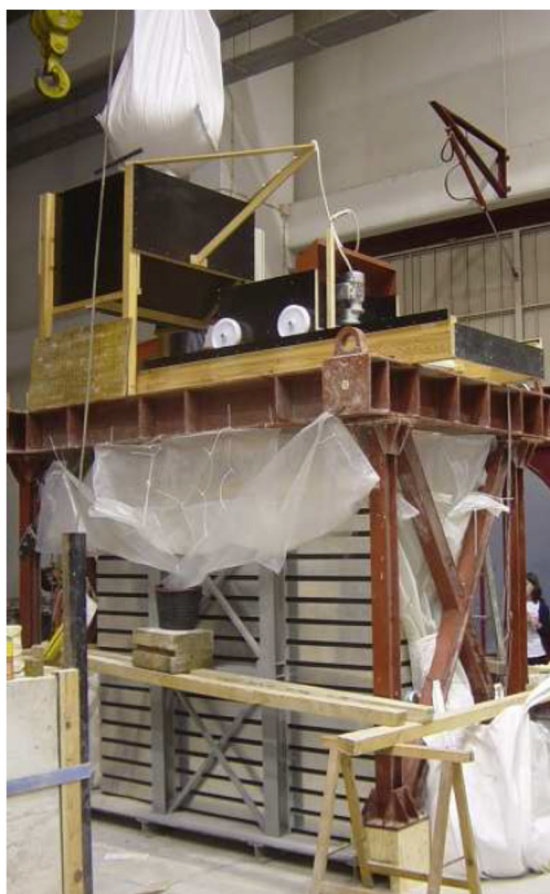
Figura 2.3 Contenitore e sistema di deposizione del LNEC
