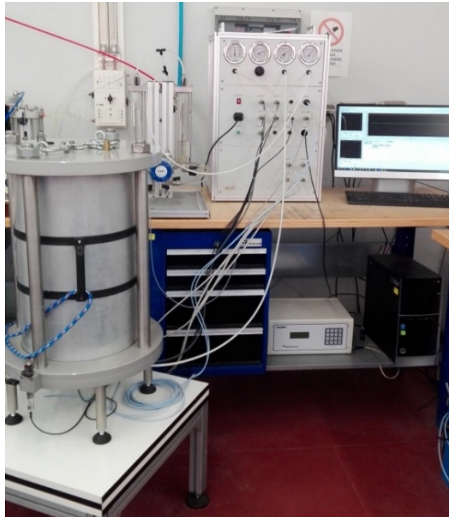
Figura 4.7 Apparecchiatura di prova di colonna risonante
