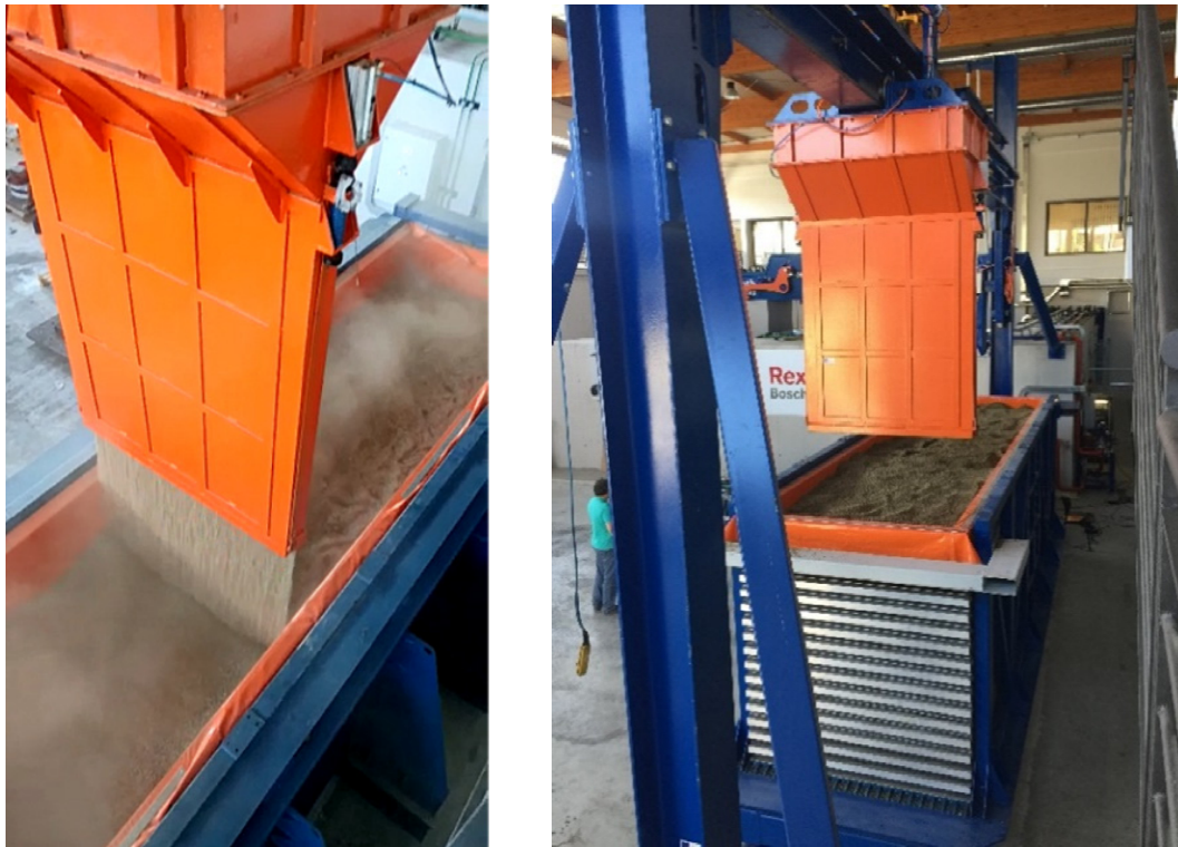
Figura 3.14 Il sistema di deposizione dell'EUROLAB-CERISI in una tipica fase di deposizione
