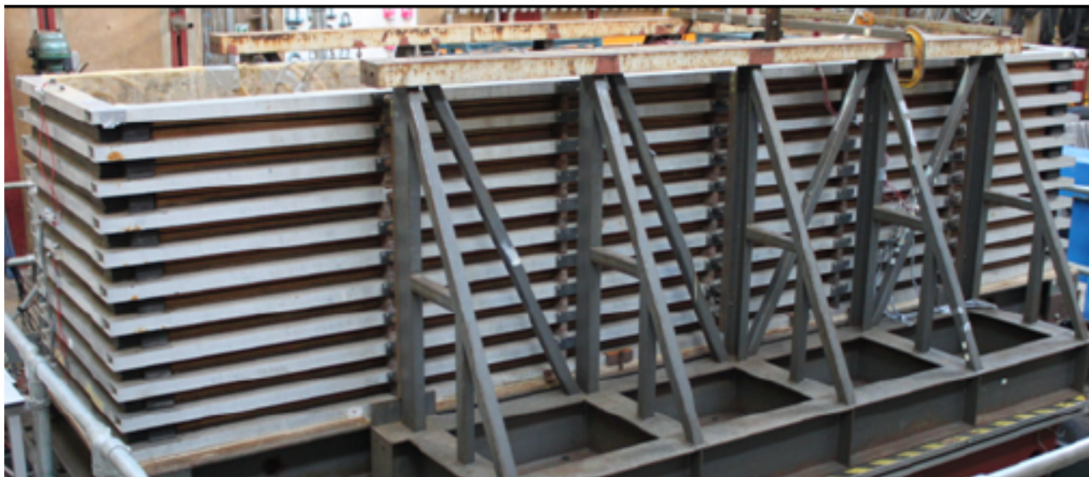
Figura 2.2 Contenitore ESB ospitato presso il laboratorio dell'Università di Bristol
