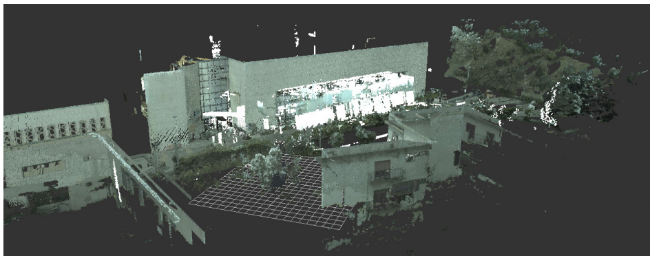
Fig. 4.26 Nuvola di punti importata su ReCap.
