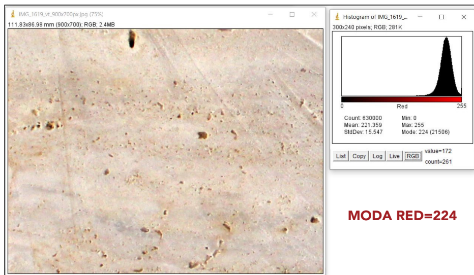
Fig. 2.12 L'analisi per immagini per valutare la componente di rosso nella scala RGB
