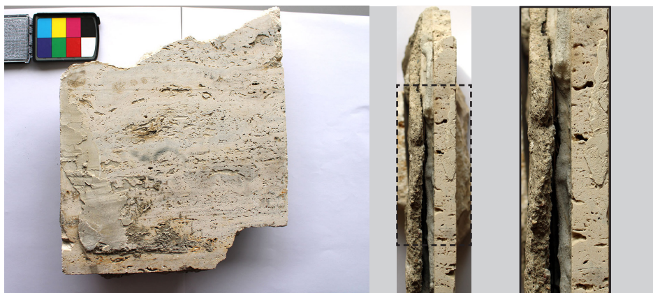
Fig. 2.4 Indagini in situ: lastra, individuata nel gruppo dei moduli dismessi, riferibile alle Manutenzioni LDO/LDV (campione serie H). Spessore di 2 cm, piuttosto che 3 cm, e doppio strato di allettamento
