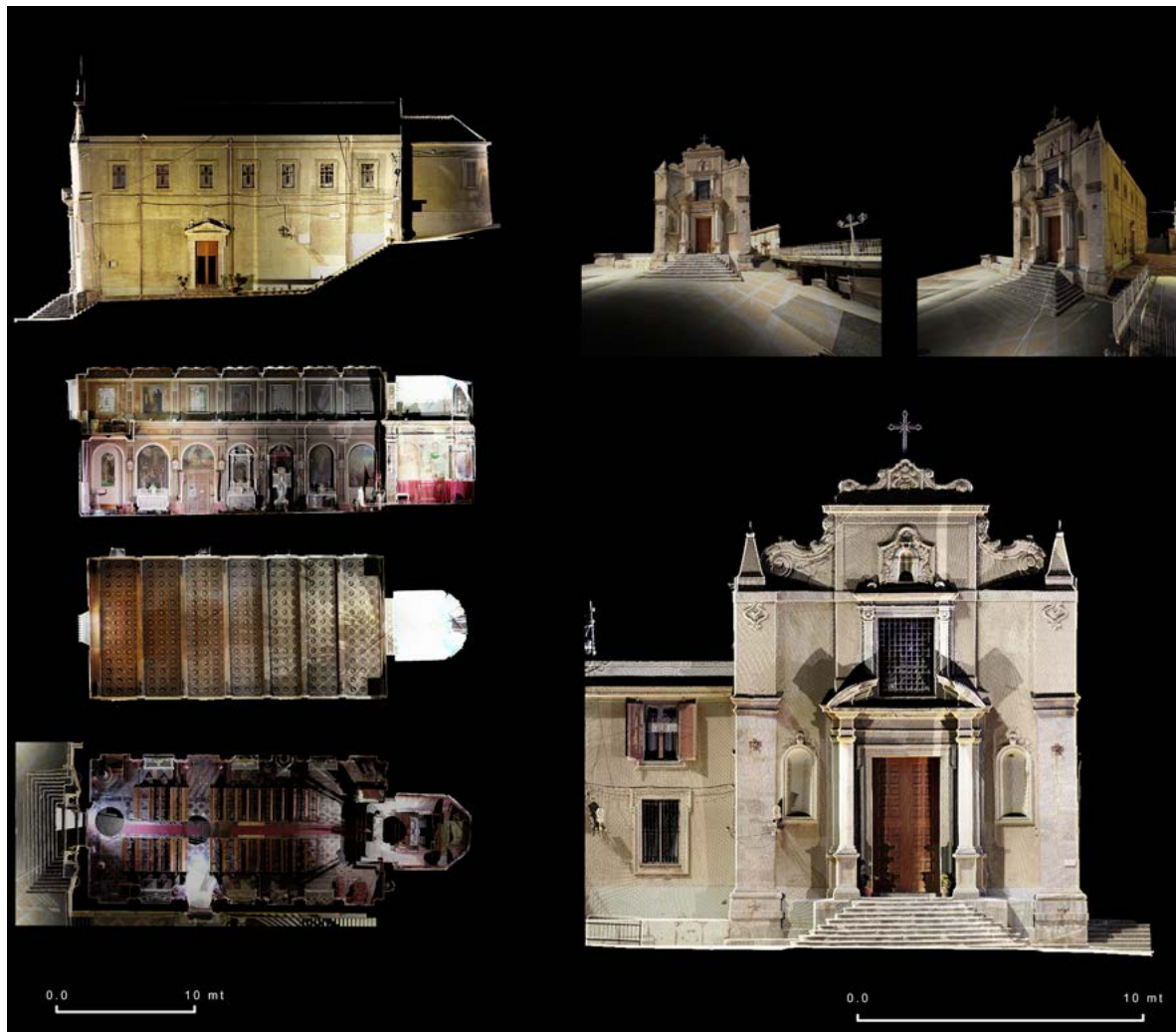
Figura 5. Casalvecchio, chiesa di Sant'Onofrio Anacoreta. Rilievo strumentale con laser scanner (elaborazione grafica a cura di M. Arena, 2019).
