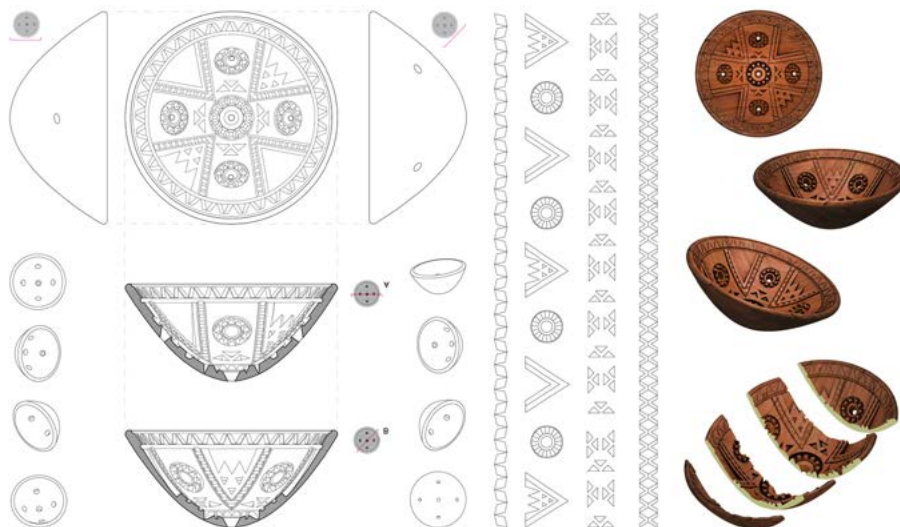
Figura 5. Musulupàra , stampo ligneo per formaggio. Palmi, Casa della Cultura “Leonida Repaci”. Rilievo, modellazione solida e analisi della forma e dei decori (disegni di M.L. Cacurri e M.T. Tortorici).
