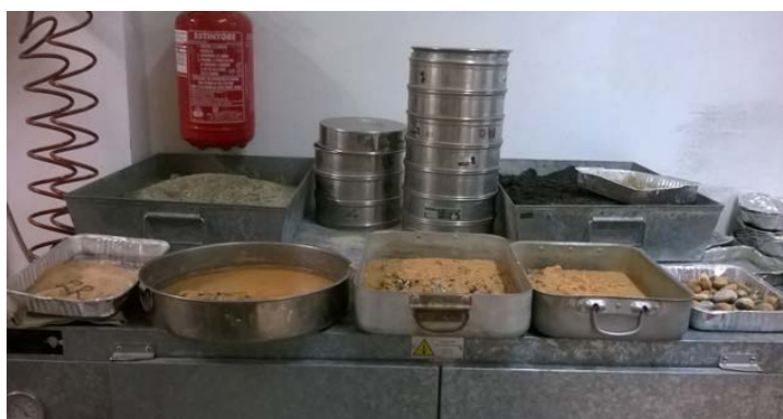
Figura 5.7 Suddivisione del provino a fine prova in tre parti, filtro superiore e filtro in geotessile
