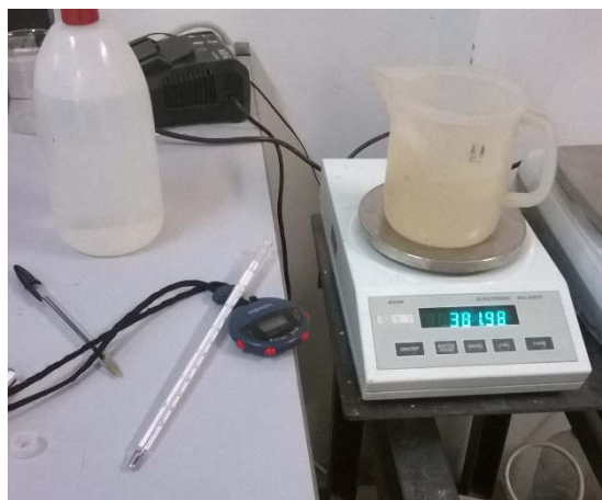
Figura 4.4 Determinazione della portata fluiva- strumentazione (contenitore per la raccolta dell'acqua, bilancia di precisione, cronometro)
