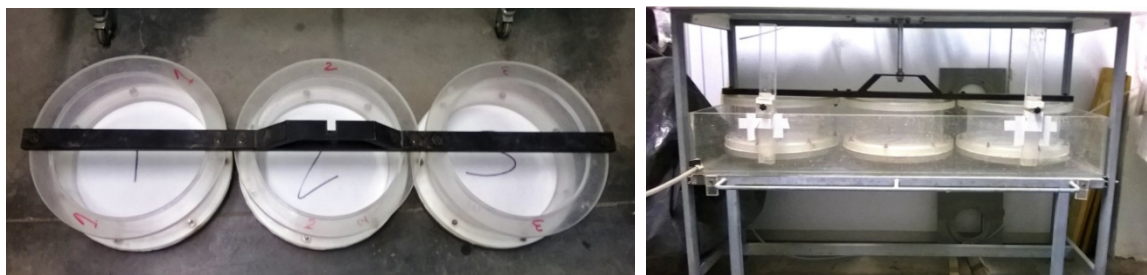
Figura 4.17 Fissaggio delle bacinelle alla traversa metallica dell'apparecchiatura
