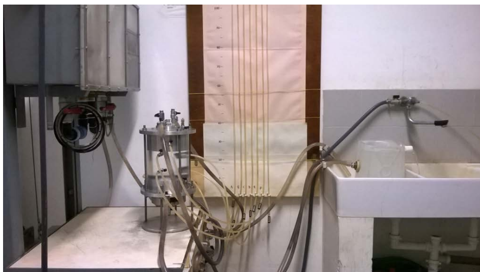
Figura 4.10 Prova sperimentale per la valutazione della permeabilità
