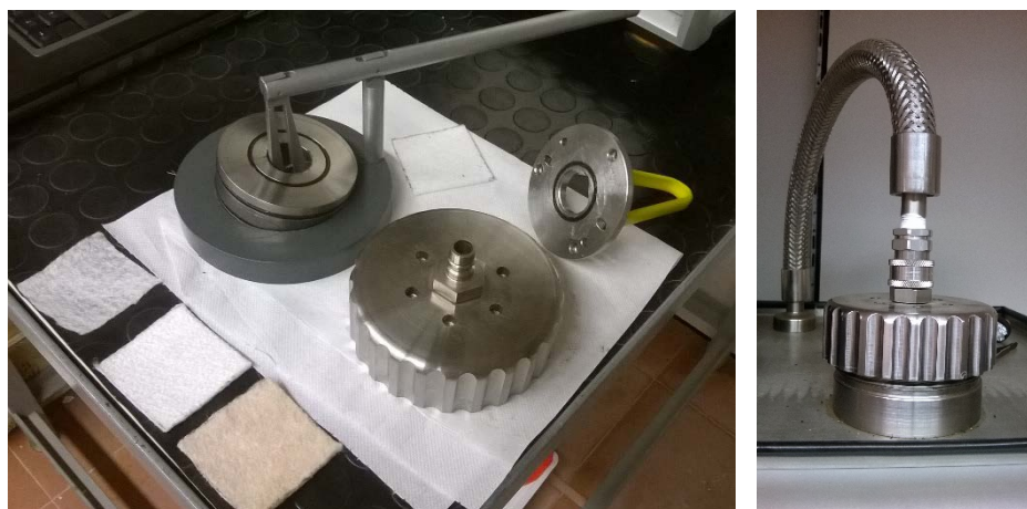
Figura 4.26 Provini di geotessile e Capillary Flow Porometer prima e dopo assemblaggio
