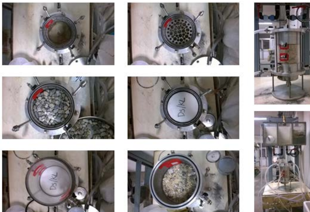
Figura 5.5 Alcune fasi della preparazione della prova di filtrazione a lungo termine
