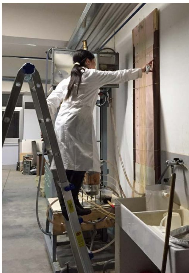
Figura 5.6 Rilevamento delle altezze piezometriche durante una prova
