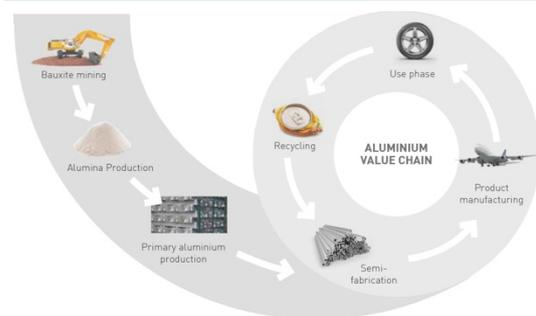
fig. 56. Sopra, European aluminium industry Sustainability Roadmap towards 2025. Sotto, ciclo produttivo dell'alluminio e riciclo. Fonte: <http://www.eaa.net>
