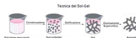
fig. 47. Procedimenti chimici per la produzione dell'aerogel
