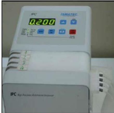
Figura 4.13: Pompa peristaltica
