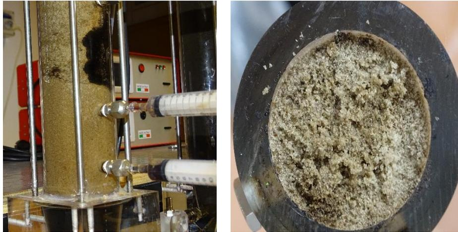
Figura 6.77: Immagini della colonna contenente la miscela Fe<sup>0</sup>-Pom (Percolato acido organico con acidi umici – v=0,027 cm/min)
