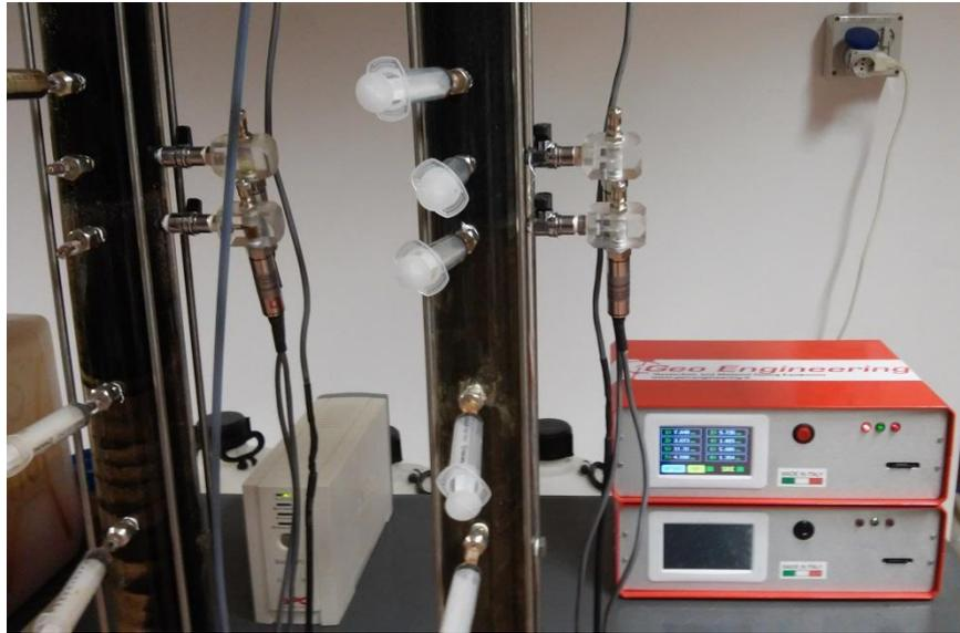
Figura 6.52: Trasduttori di pressione
