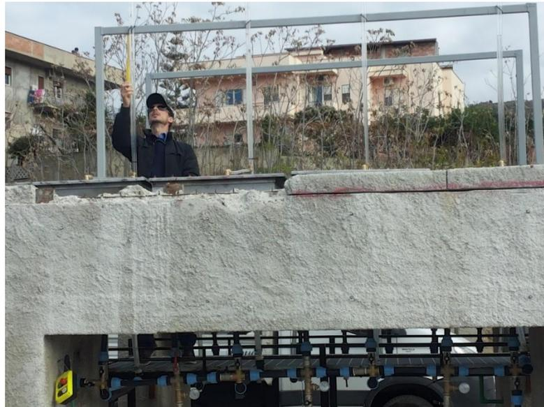
Figura 7.19: Installazione sistema di controllo del carico idraulico.
