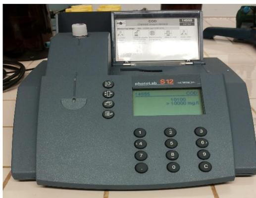
Figura 4.17: Fotometro a filtro PhotoLab S12
