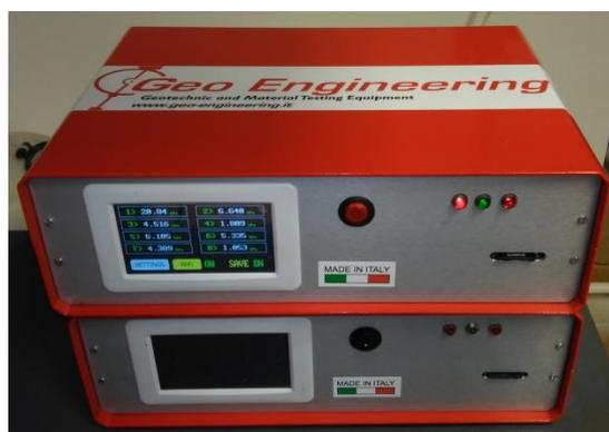
Figura 6.51: Centralina di acquisizione dei valori di pressione.
