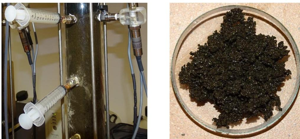
Figura 6.80: Immagini della colonna contenente CAG (Percolato acido organico con acidi umici –  $v=0,027$  cm/min)
