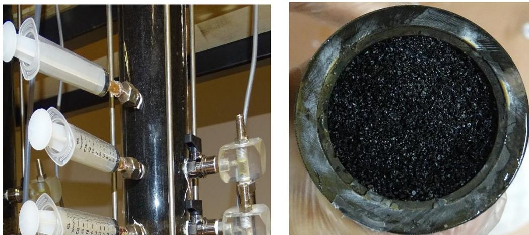
Figura 6.79: Immagini della colonna contenente CAG (Percolato acido organico con acidi umici –  $v=0,027$  cm/min)
