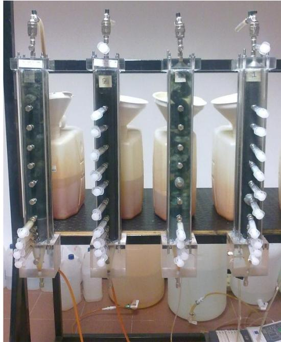
Figura 4.12: Apparecchiatura per le prove di interazione in colonna
