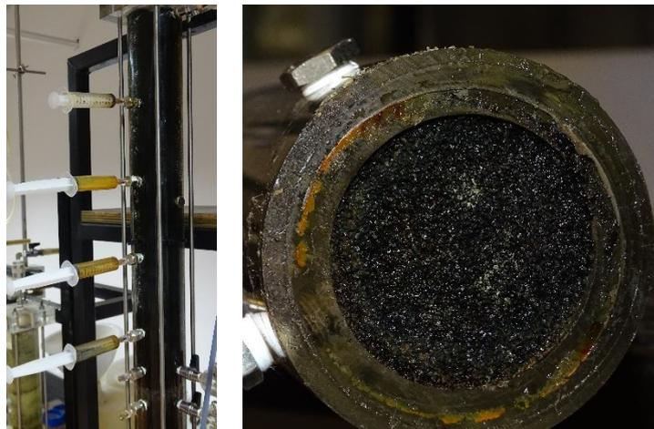
Figura 6.78: Immagini della colonna contenente la miscela Fe<sup>0</sup>-CAG (Percolato acido organico con acidi umici – v=0,027 cm/min)
