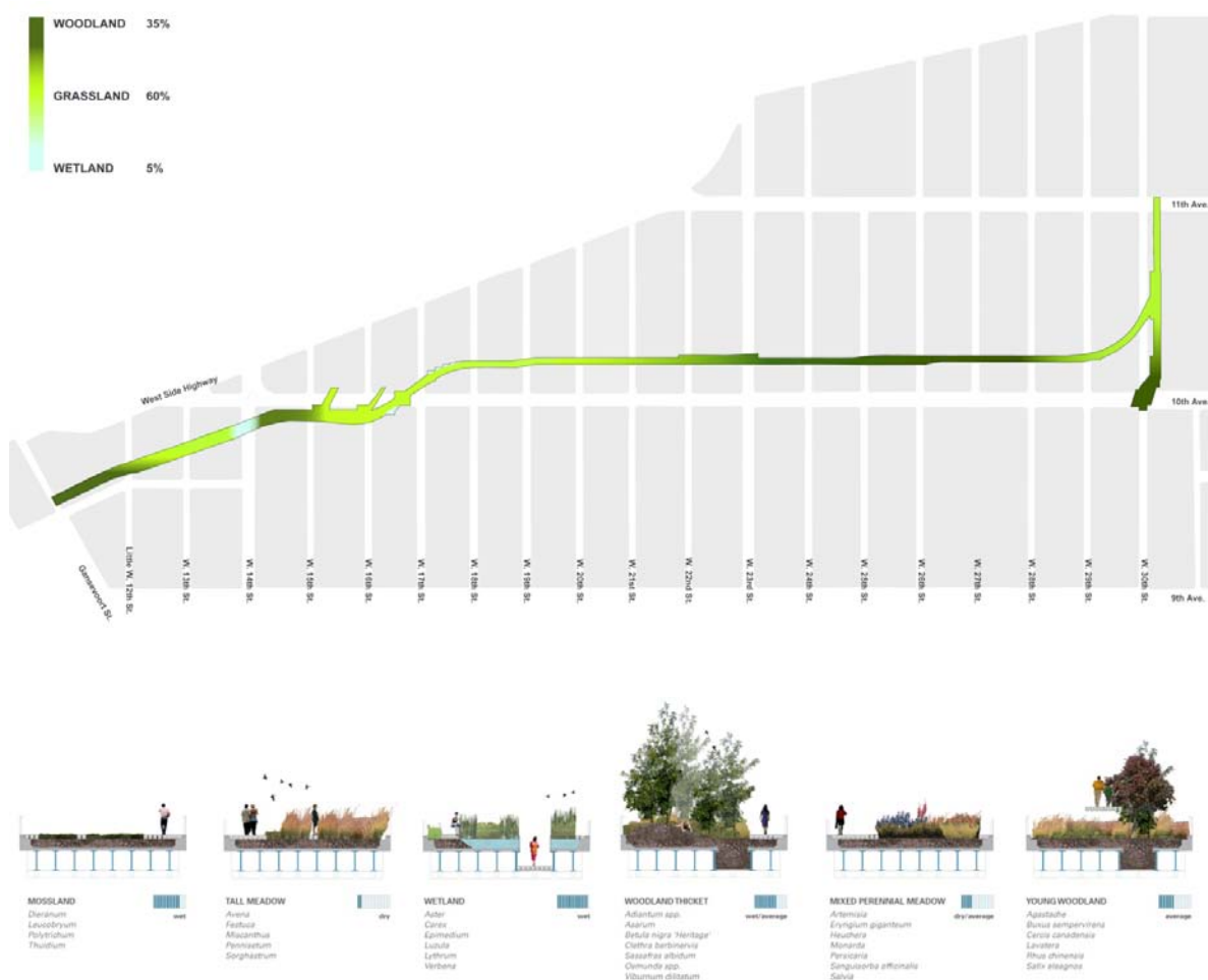
fig.59. High Line Park - Schema dei differenti habitat, permeabilità delle superfici.
