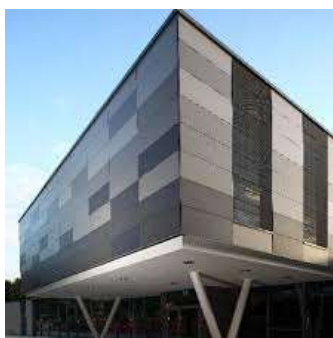
Figura 12. Edificio con evidente contrasto tra la compattezza della forma in elevato e la snellezza dei pilastri 23
