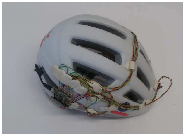
Figura 4-8 – Caschetto realizzato con gli accelerometri
