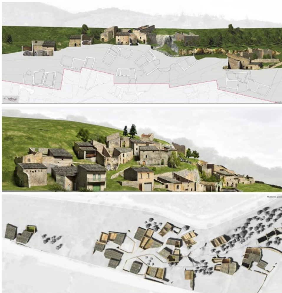
Figura 3. Secinara (L'Aquila). Rilievi in pianta e in alzato dei resti delle cosiddette "pagliare", edifici che costituiscono l'ossatura portante delle frazioni rurali dell'Abruzzo interno (disegni di V. Panicali, ALabRes, 2009-2010).
