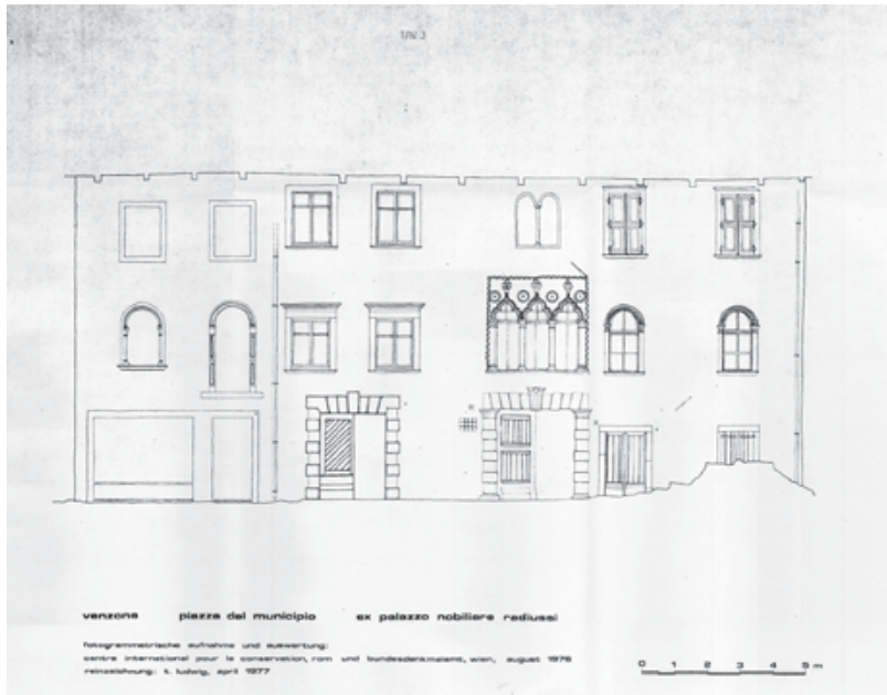
Figura 5. Restituzione del rilievo, realizzato nell'estate del 1976, di palazzo Radiussi in piazza del Municipio a Venzone. Dopo la seconda scossa del 15 settembre non rimase più nulla del palazzo; come tutte le riprese fotogrammetriche si rivelò fondamentale per il Piano di ricostruzione del centro (ACV, Ufficio tecnico, Piano per la ricostruzione).
