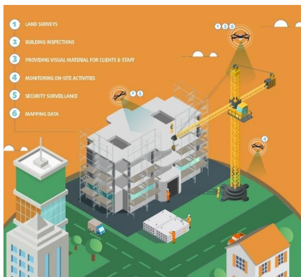
Figura 33 - Applicazione UAV in cantiere
