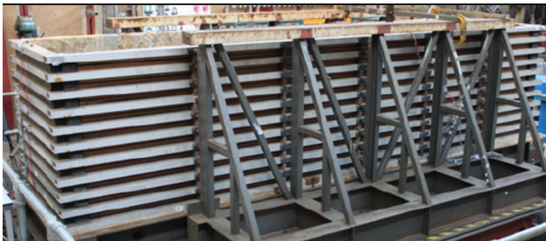
Figura 2.2 Contenitore ESB ospitato presso il laboratorio dell'Università di Bristol
