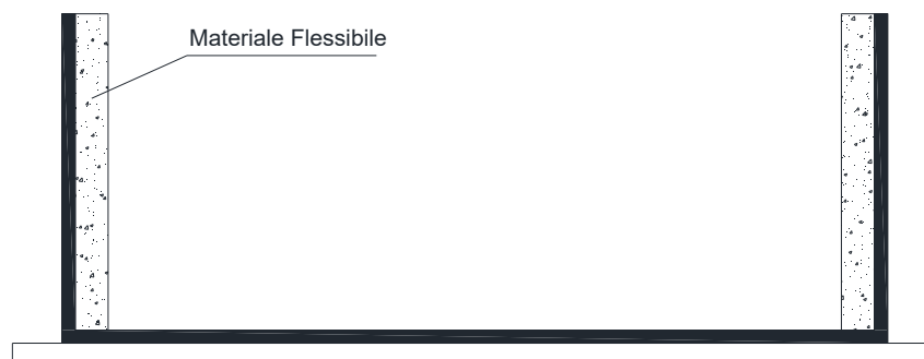
Figura 1.5 Schema di un contenitore rigido con pareti laterali flessibili
