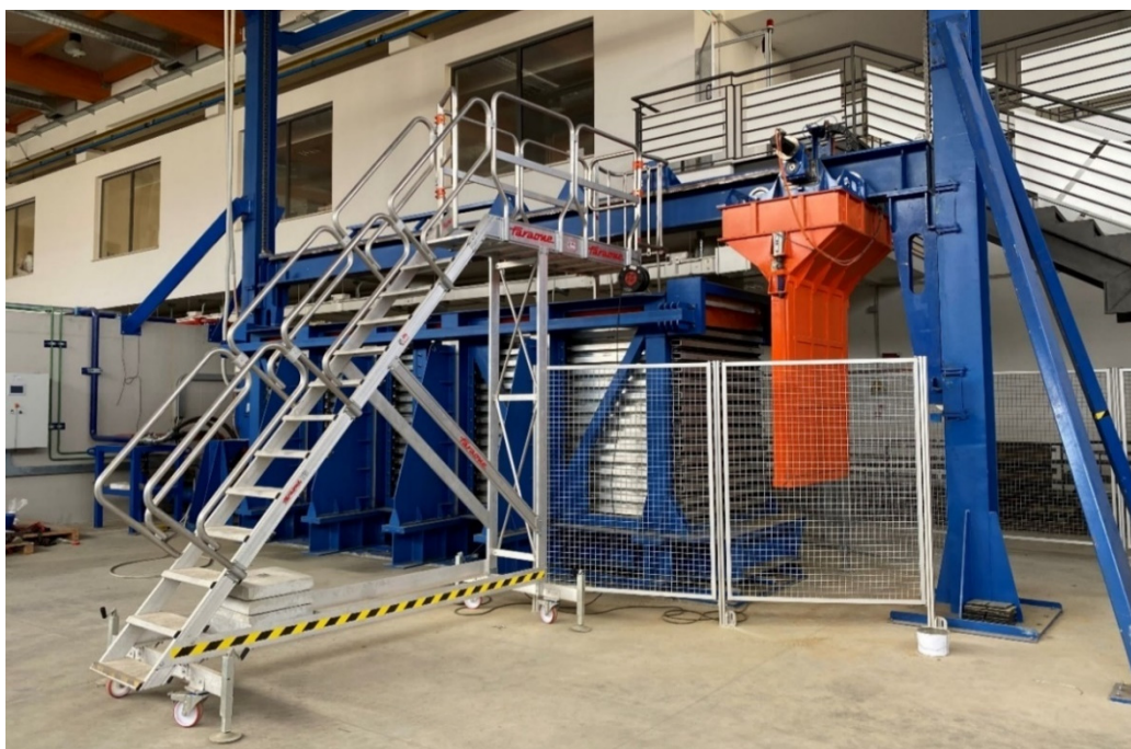
Figura 5.32 Scala utilizzata per l'accesso all'interno del contenitore ESB
