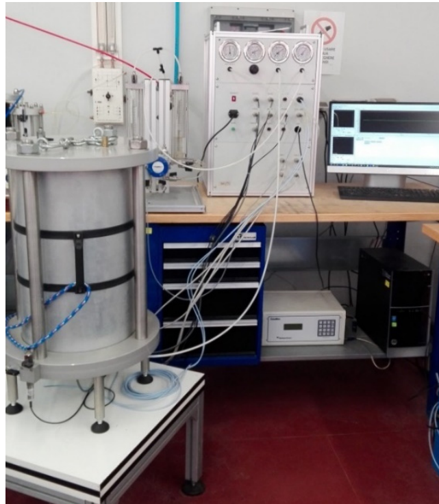
Figura 4.7 Apparecchiatura di prova di colonna risonante
