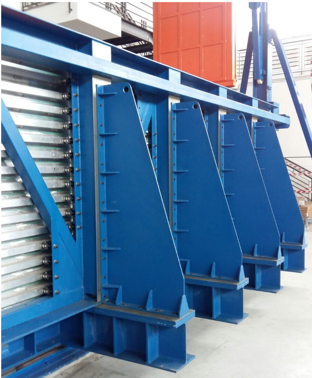
Figura 3.12 Telaio di rinforzo trasversale
