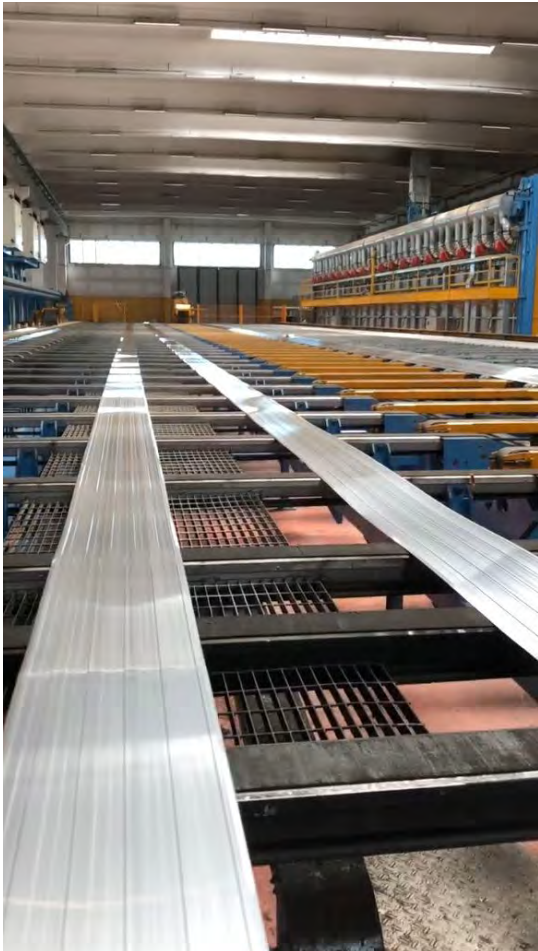
Profili in alluminio anco a da tagliare presso l'impianto di estrusione Anodall di Trevenzuolo (VR)
