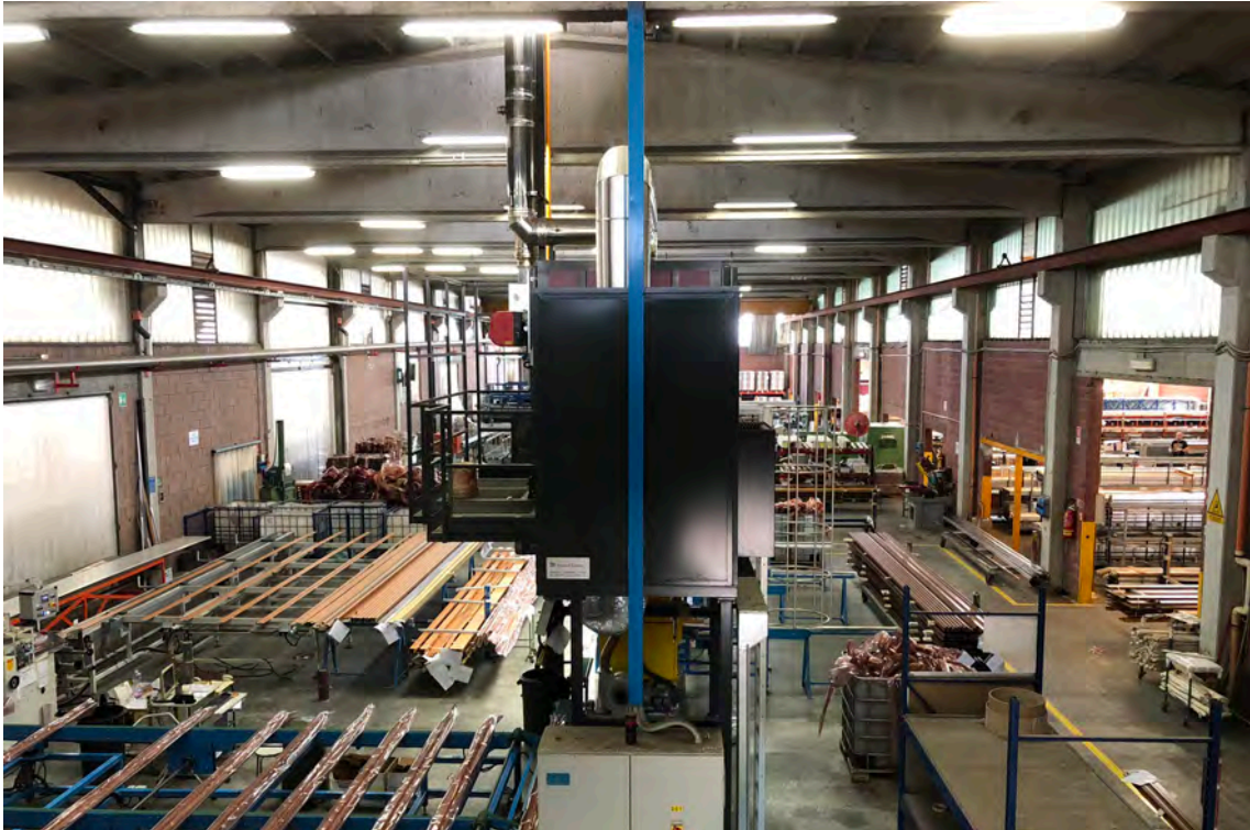
L'impianto di produzione Aluk di Isola della Scala (VR). Vista dell'impianto di sublimazione effetto legno.
