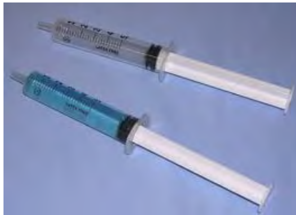
Esempi di comprimibilità dei fluidi all'interno di una siringa piena d'acqua e d'aria.
