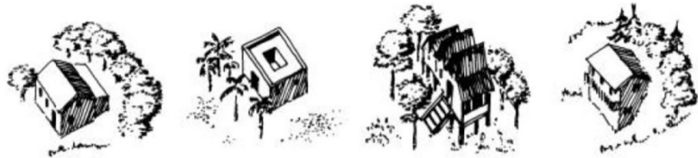
fig. 15. La copertura in funzione della bioclimatica. Da sinistra, clima temperato, clima caldo secco, clima caldo umido, clima freddo. (fonte: Criteri di progettazione sostenibile, G. Sciuto, Università di Catania.)
