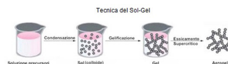
fig. 47. Procedimenti chimici per la produzione dell'aerogel
