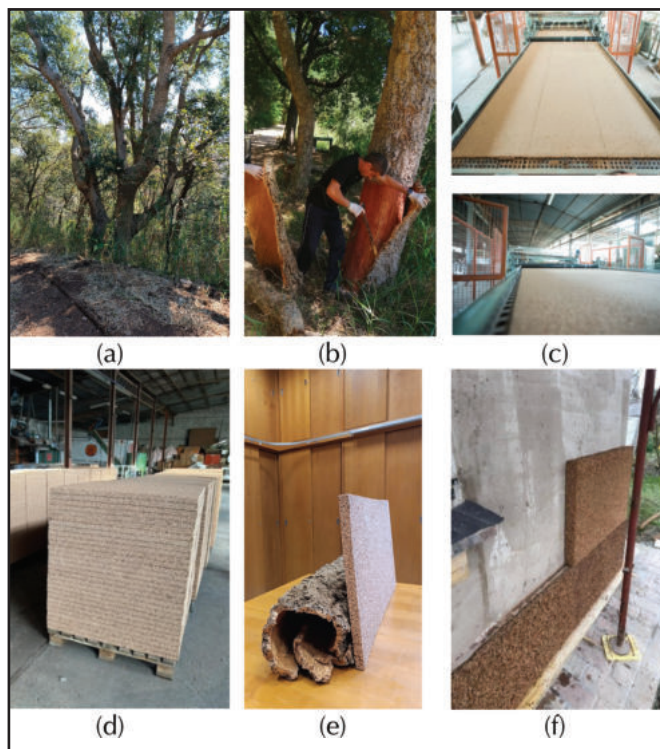
Figura 1 - Processo di produzione del pannello di sughero: a) foreste, origine naturale del ciclo del sughero; b) decortica del sughero; (C-D) Produzione di pannelli in sughero naturale organico ecologico; e) Sughero: corteccia grezza e pannelli per edifici verdi; f) Tavole/pannelli di sughero ecologico rendono l'edificio: Verde e sano. Fonte: Autori.
